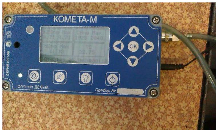
Рис 1б Газоанализатор «Комета-М-4»
