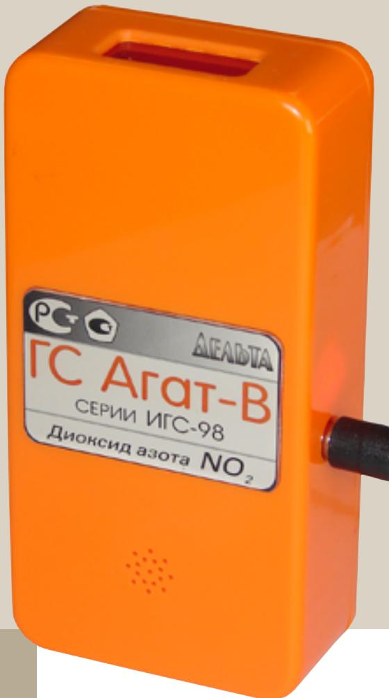
Принцип действия схемы контроля концентраций кислорода и токсичных газов основан на амперометрическом методе измерения, при котором электрохимический сенсор преобразует значение концентрации соответствующего газа в атмосфере в электрический сигнал, сила тока или напряжение которого пропорциональны величине концентрации.
