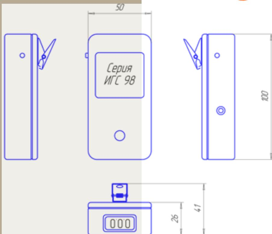
Принцип действия схемы контроля концентраций кислорода и токсичных газов основан на амперометрическом методе измерения, при котором электрохимический сенсор преобразует значение концентрации соответствующего газа в атмосфере в электрический сигнал, сила тока или напряжение которого пропорциональны величине концентрации.
